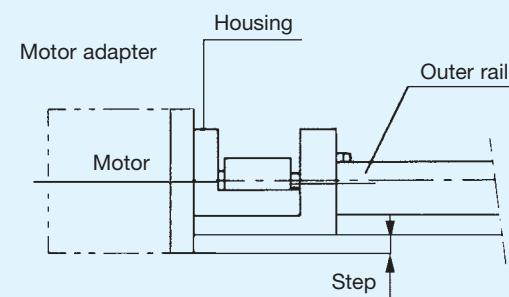
Fig. 19 Motor-Connection
